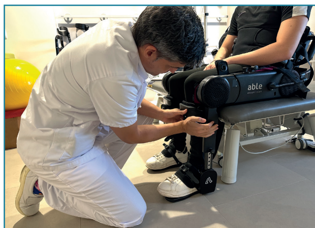
Figura 2. Ajuste global del exoesqueleto en sedestación realizado por el fisioterapeuta, asegurando la correcta alineación articular y el posicionamiento adecuado de los segmentos del dispositivo antes del inicio del entrenamiento en bipedestación y marcha asistida.
