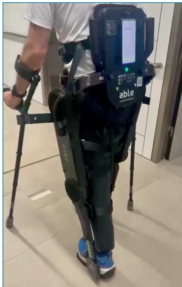
Figura 6. Entrenamiento de un patrón de marcha en 4 puntos con muletas en un paciente con lesión medular incompleta en fase subaguda. Se observa la ejecución de la marcha asistida con exoesqueleto, con participación activa del paciente y supervisión constante del fisioterapeuta, tras alcanzar un adecuado control postural y manejo del dispositivo.
