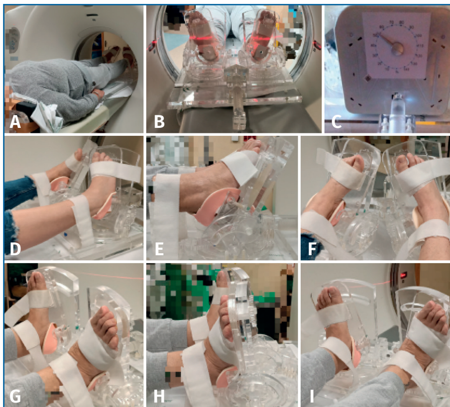
Figura 4. A: dispositivo de carga simulada ajustable (DCSA). Este dispositivo se aplica sobre una mesa convencional; B: tornillo sin fin que permite aplicar fuerza axial; C: dinamómetro que permite ajustar la fuerza axial al peso corporal; D-F: pies en 30° de flexión plantar, 15° de inversión y 20° de rotación interna (posición de relajación de la sindesmosis); G-I: pies con 15° de flexión dorsal, 15° de evasión y 30° de rotación externa (posición de estrés de la sindesmosis). Imagen publicada originalmente en Chans-Veres et al., 2022, incluida en la tesis doctoral Análisis de la sindesmosis tibioperonea empleando TAC convencional y dispositivo de carga simulada ajustable (Universidad de Sevilla, 2003) (15-17) . Disponible en: https://hdl.handle.net/11441/147720 (Figura 22).
