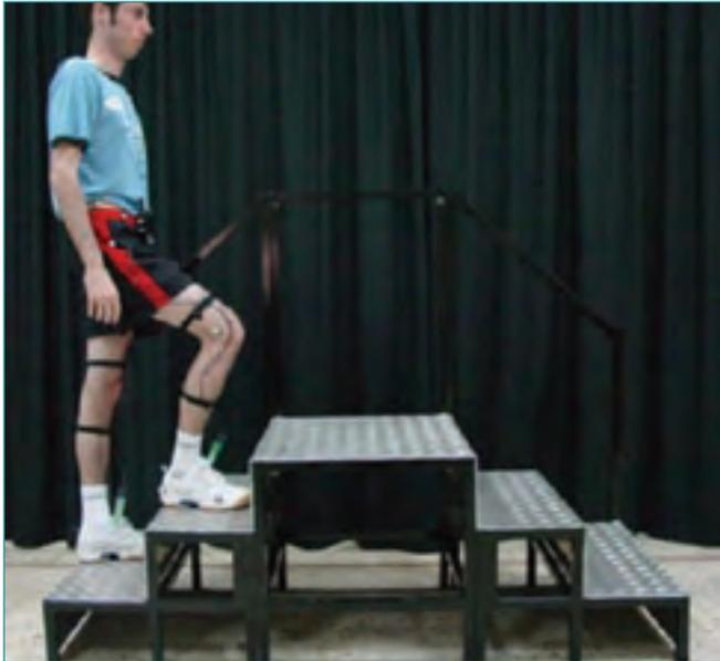
**Figura 1.** Escalera modular diseñada para poder filmar desde un lado y permitir el apoyo de la mano, en discapacitados, por el otro.
