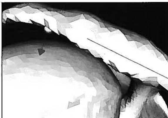
Figura 6. Visualización de la imagen obtenida con el empleo del controlador háptico. La esfera azul representaría el extremo de nuestro palpador y el vector rojo representa la reacción a la fuerza aplicada para palpar en este caso a la zona subacromial. Los otros ejes son las referencias de nuestra situación espacial.
